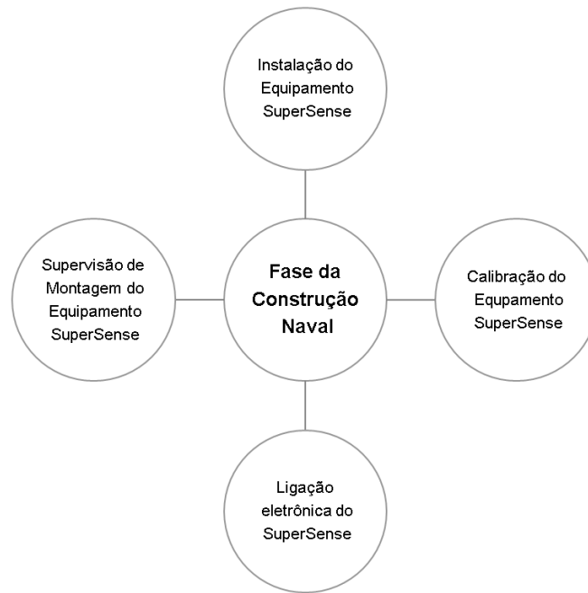
Figura 13 – Diagrama esquemático de monitoramento. Fonte: O Autor e [64]
