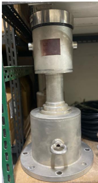
Figura 11 – Vaso contendo eletrônica. Fonte: O autor e [64]
