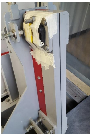
Figura 30: Equipamento de medição fixado na parede externa de saída do feixe de raios X, dentro da cabine onde fica o acelerador, referente ao ponto 2.
