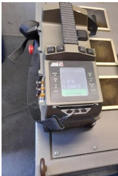
Figura 33: Equipamento SpiR-ID colocado na parte superior do Modulador, dentro da cabine onde fica o acelerador - Ponto 1.
