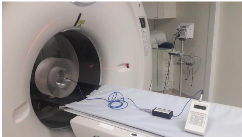
Figura 2: Posicionamento do objeto simulador padrão de corpo, com a CITL inserida no orifício central para a dosimetria, no interior do gantry (Fonte: o autor).
