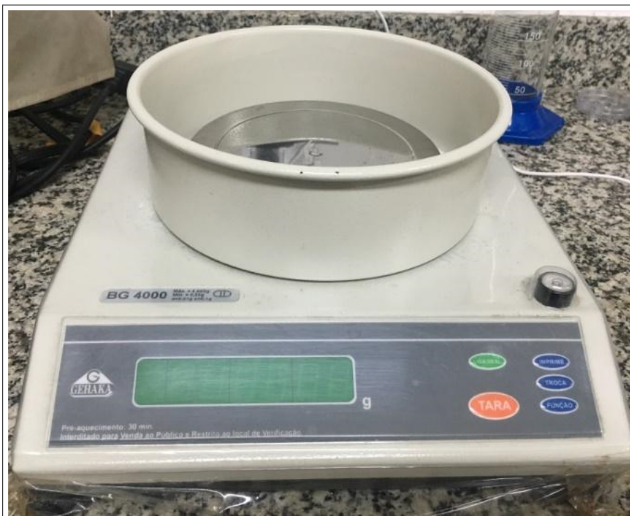
Figura 4.3: Balança de precisão Gehaka modelo BG 4000.
