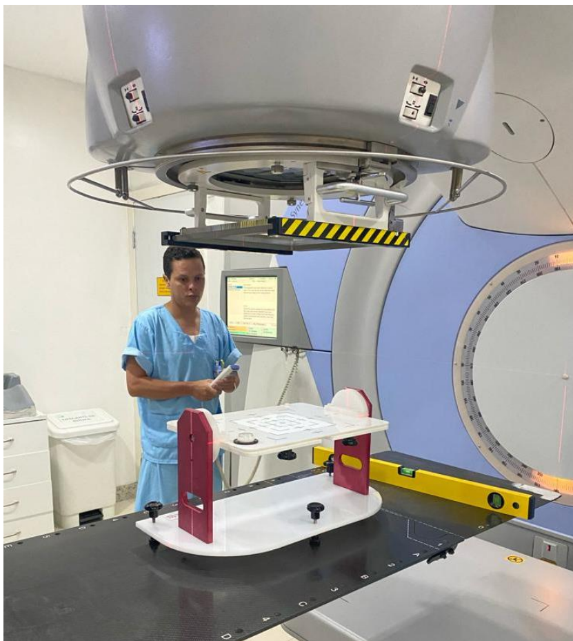
Figura 7 – Isoline centralizado ao feixe luminoso do colimador
