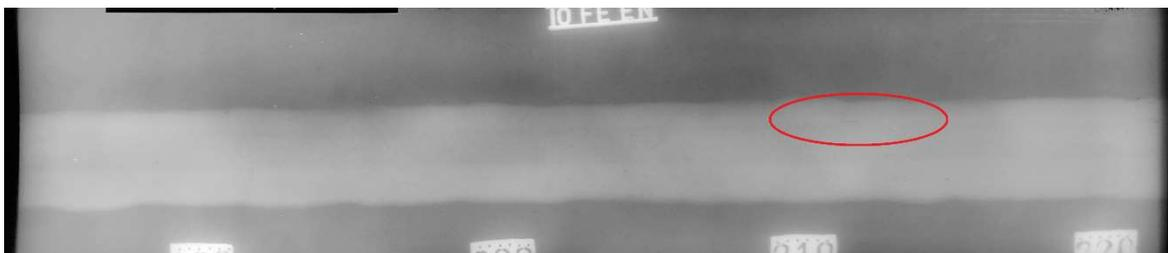
Figura 3: Exemplo de falta de fusão em uma radiografia de soldagem
