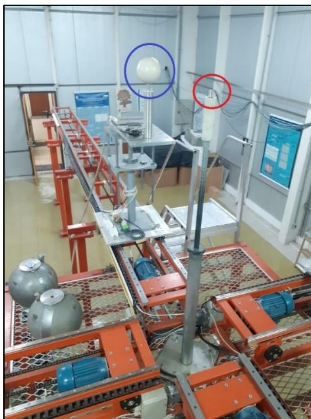
Figura 14 - Foto do sistema de EMB. Posicionamento da esfera moderadora no detector (em azul) e posicionamento da fonte de ^{241}\text{AmF} (em vermelho) no salão de baixo espalhamento do LN. (Autor, 2024).
